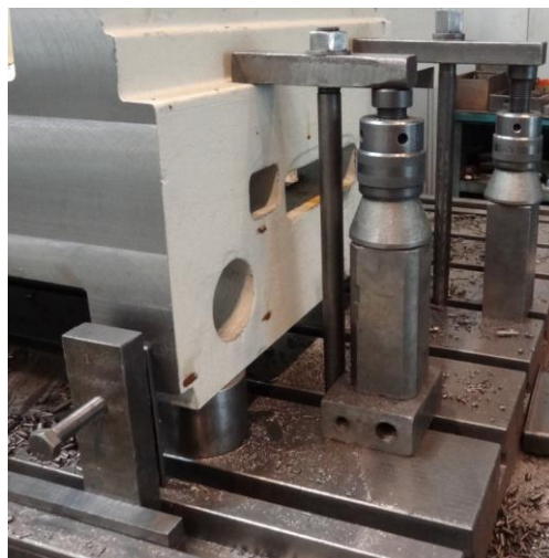
Obr. 4.8 Upnutí obrobku pomocí upínek, šroubů a podpěr
