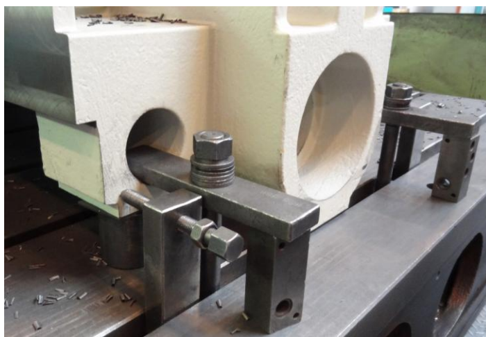
Obr. 4.10 Upnutí obrobku pomocí upínek, šroubů a podpěr
