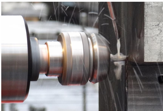
Obr. 4.11 Upínací hlavice s kleštinou
