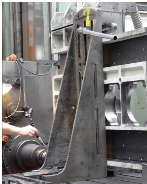
Obr. 4.12 Upnutí obrobku pomocí úhelníku
