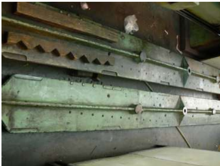
Obr. 3.11 Výměnná vodící pravítka pro výrobu progresivního drážkování
