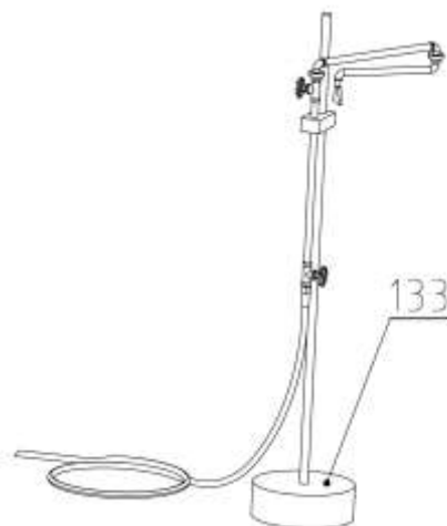
Obr. 3.28 Stojan s přívodem řezné kap. k přední koncové poloze nástroje
