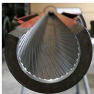
Obr. 1.5 Řez 105mm tankovou hlavní L70 [7]
