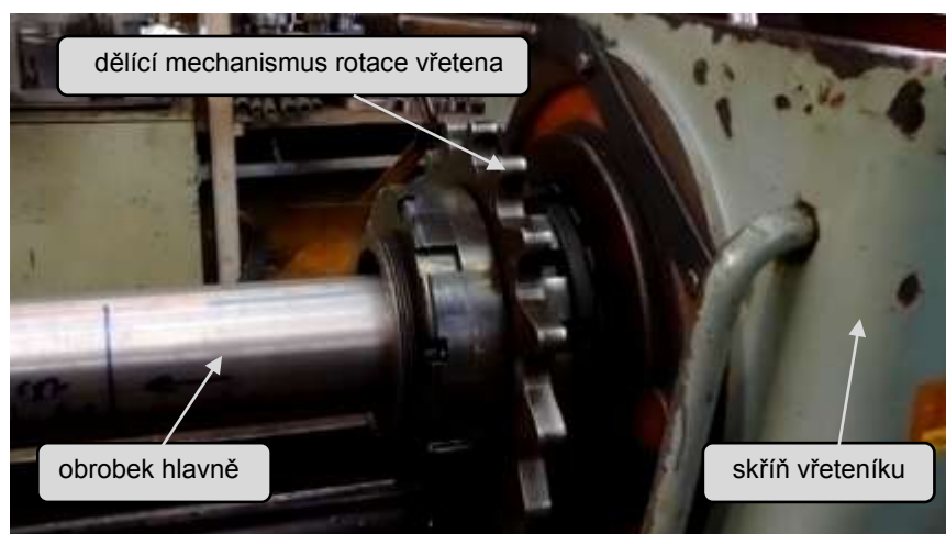
Obr. 3.20 Levá strana celku vřeteníku s upnutou hlavní
