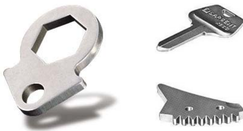
Obr. 15 Súčiastky vyrobené technológiou presného strihania s obvodovou hranou [14][15]
