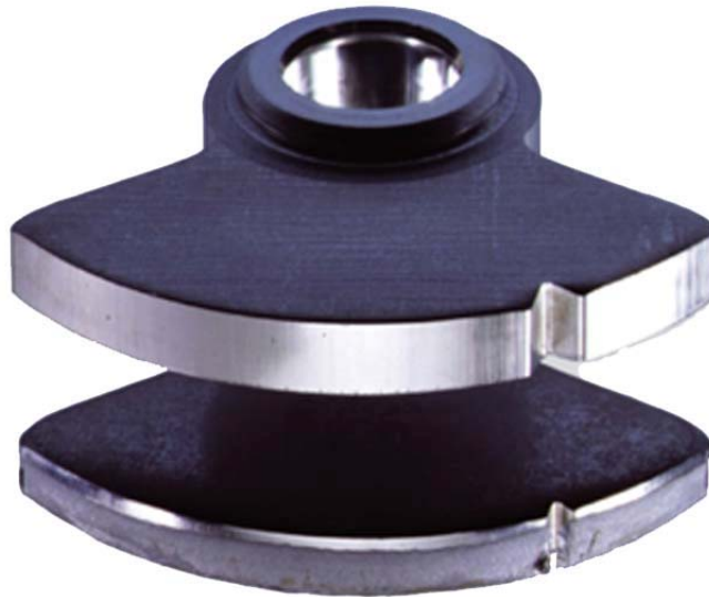
Obr. 18 Rozdiel rozmerovej presnosti a drsnosti povrchu súčiastky vyrobenej konvenčným strihaním (dole) a presným strihaním s obvodovou hranou (hore) [12]
