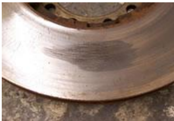
Obr. 57 Martenzitická povrchová skvrna [21]
