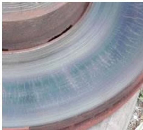
a) vlasové trhliny
