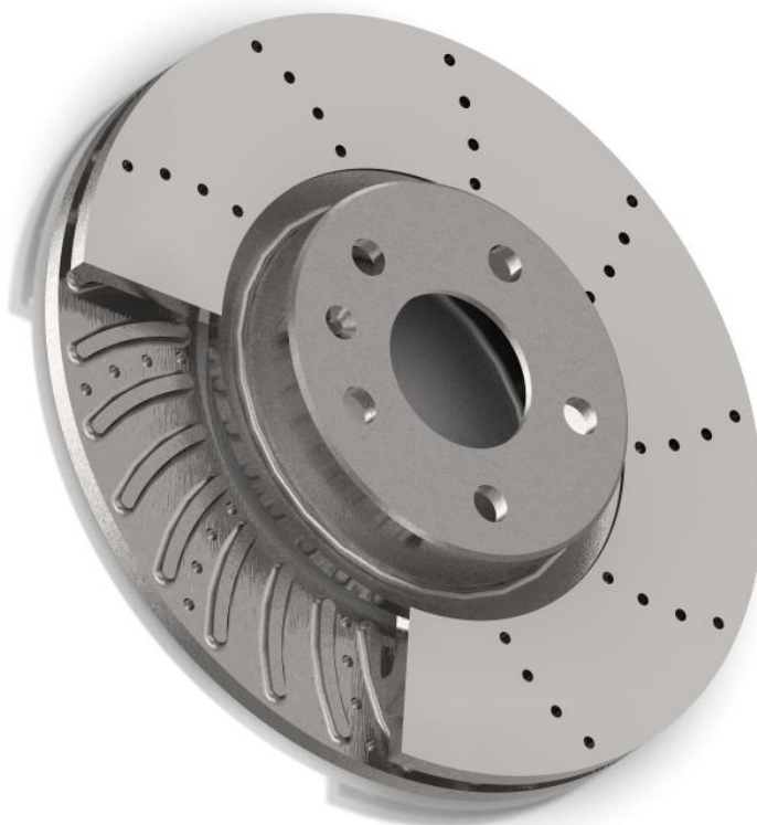
Obr. 25 Model vnitřně chlazeného, vrtaného brzdového kotouče v částečném řezu
