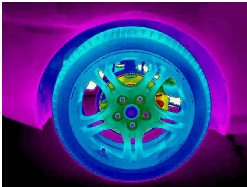
Obr. 12 Termovizní měření brzdového kotouče s kolem automobilu [13]
