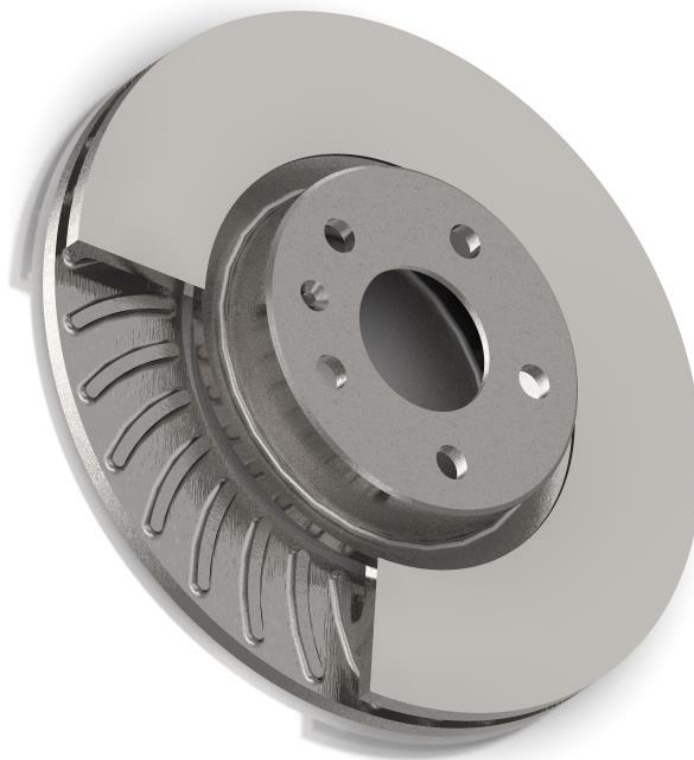
Obr. 24 Model vnitřně chlazeného brzdového kotouče v částečném řezu
