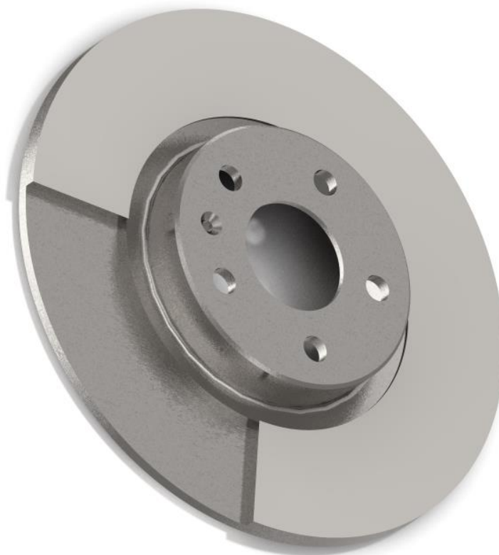
Obr. 23 Model plného, nechlazeného brzdového kotouče v částečném řezu
