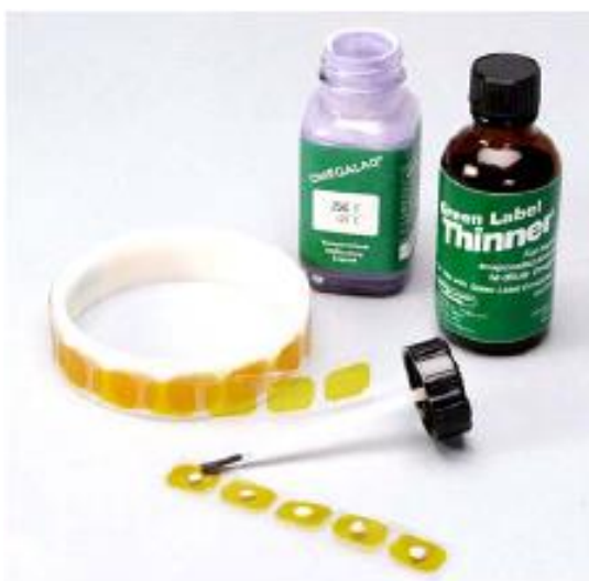
Obr. 10 Teplotně citlivé barevné nálepky [9]
