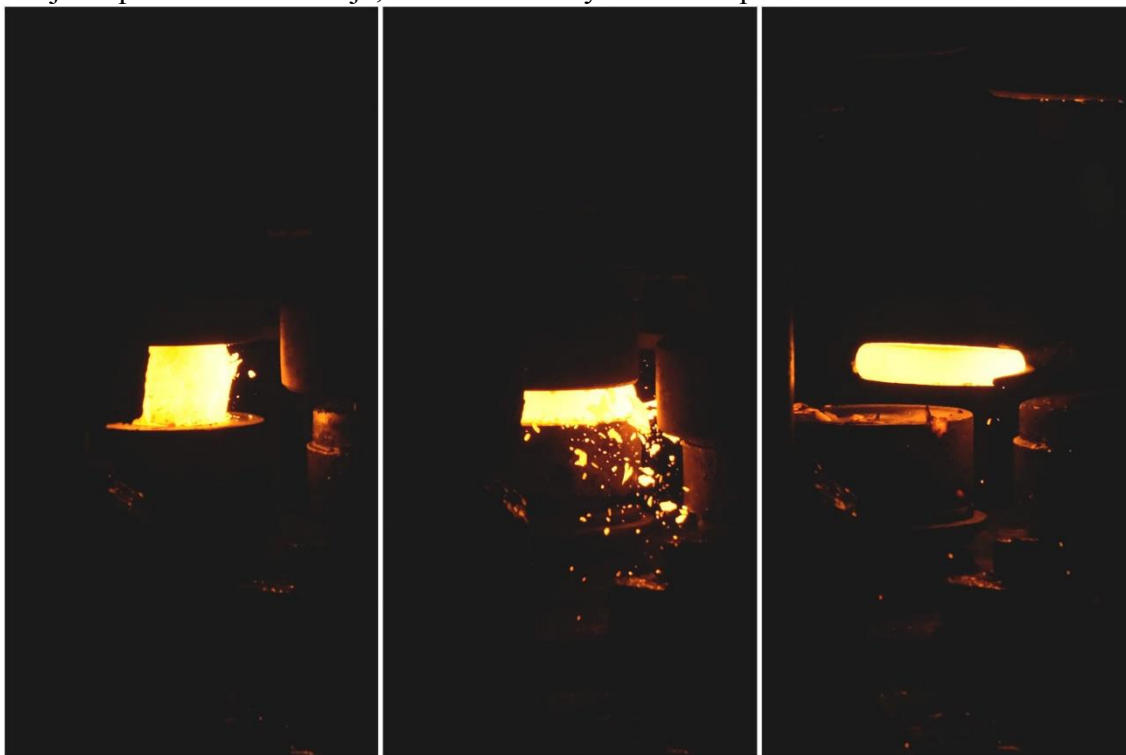
obr. 20 Napechovanie valcového prírezu
